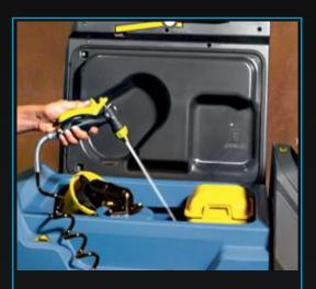
La EMX BT peut être équipée en option du pulvérisateur pour le nettoyage du réservoir d'eau sale,
