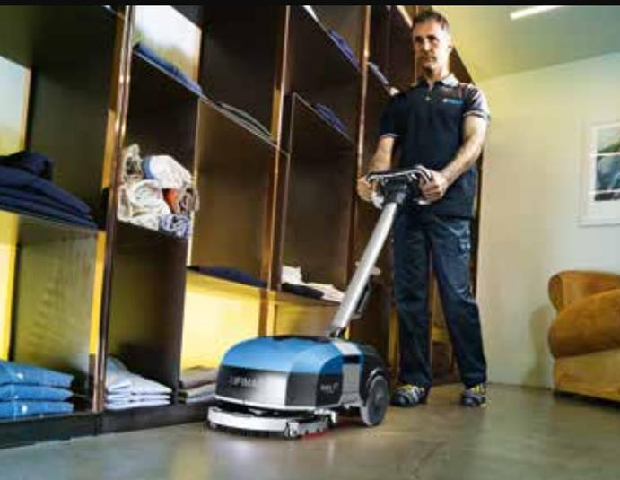
Le groupe brosse est déplacé latéralement par rapport au corps de la machine, ce qui permet de nettoyer parfaitement le long des murs et d'hygiéniser ainsi toute la surface utile de la pièce.
